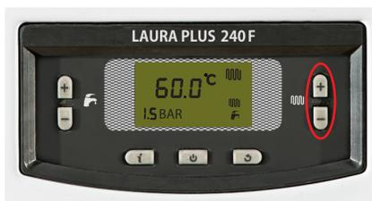
۴ در این حالت جهت رسیدن به دمای تعریف شده، مشعل دستگاه روشن می شود و علامتهای (H) و مقدار قدرت مشعل به صورت به فرض مثال به صورت (۴۵%) روی LCD نمایش داده می شوند. مقدار دمای نشان داده شده، دمای خروجی مدار گرمایش می باشد.
