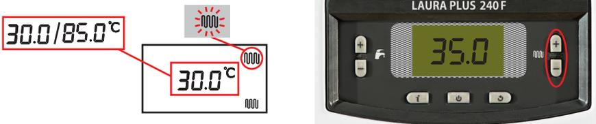
۴ زمانیکه دمای مدار گرمایشی به مقدار دمای انتخاب شده رسید، مشعل دستگاه خاموش می شود. به عنوان مثال: دمای انتخاب شده 60.0 درجه می باشد.
